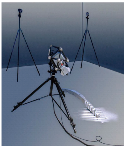
图5 Aicon扫描仪与Metronor跟踪系统协同测量
